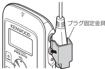
金具の左にある爪をスピーカー / マイクロホン端子部分の溝に合わせます。
