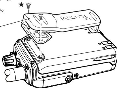
※ネジの長さは、ベルトクリップの種類(P.10-2)によって異なります。
