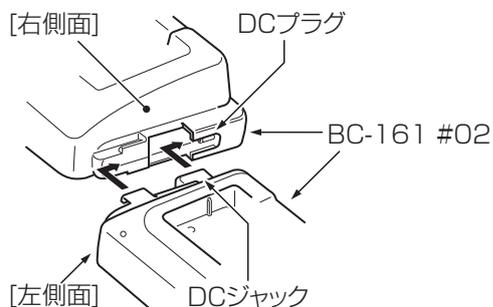
3. 底面部(2台目のBC-161 #02)にある連結板を固定するネジ(2本)を取りはずして、連結板を1台目の充電器のほうに移動させます。
