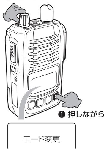
3. 「モード変更」と表示されて「ピッ」と鳴ったら、すべてのスイッチから手をはなして、1秒以内に[機能/電源]スイッチを短く押します。
