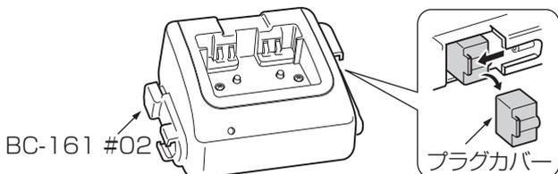
2. 右側面にあるDCプラグと、もう1台のBC-161 #02(左側面)にあるDCジャックを「カチッ」と音がるまで差し込みます。
