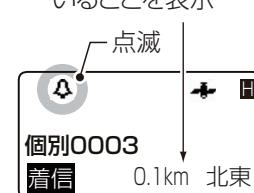
※発着信履歴機能が設定されているときは、着信履歴から、移動局の位置情報を確認できます。(☞P8-8)
