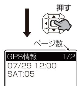
測位日時と追尾衛星数(SAT)の表示例
