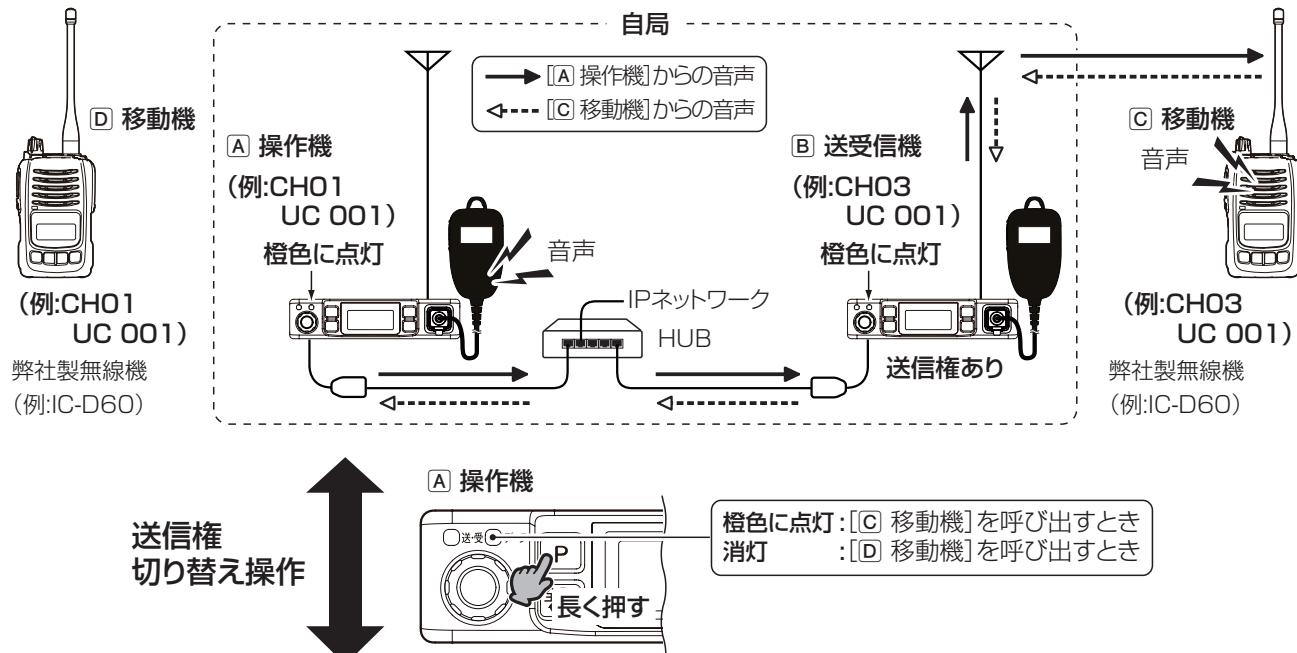
[A] 操作機]から[D] 移動機]を呼び出すとき
