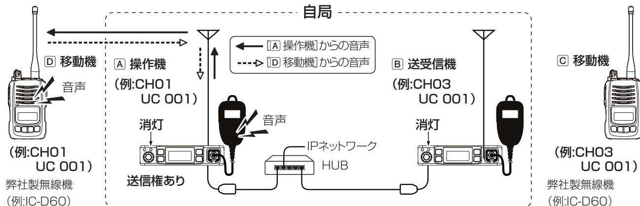
★送信権の切り替えは、詳細設定モードで、設定されているときだけ、操作できます。(☞P9-2)
