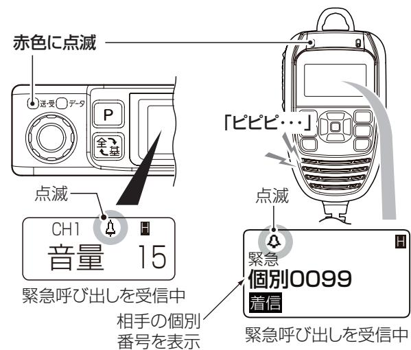
②操作機の【PTT】(送信)スイッチを押して、応答します。
