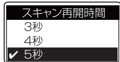
スキャン停止時間が経過する前に電波が途切れたとき、スキャンが再開するまでの時間を設定します。
