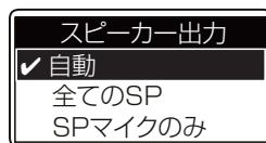
外部スピーカーを接続したとき、スピーカーマイク(弊社製)から受信音を出力するかしないかの設定です。
