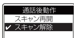
スキャン中、[PTT](送信)スイッチを操作したときのスキャン動作を設定します。
