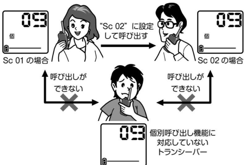
個別呼び出し機能を使用する場合、「自局の個別呼び出し ID」と「自局のグループ」を設定します。設定方法を以下に示します。
